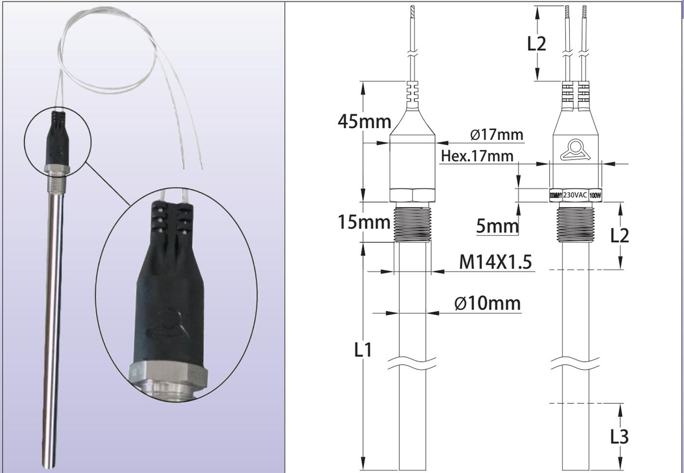
**Hauptanwendungen:** Beheizung von Flüssigkeiten, wenn der für das Heizelement zur Verfügung stehende Platz begrenzt ist. Z. B. Beheizung von Ölversorgungssystemen, Ölfiltren, Sumpfmotoren, Getrieben, Hydraulikaggregaten. Das Heizelement hat einen integrierten Thermostat. Es ist das kleinere Heizelement mit integriertem Thermostat.
