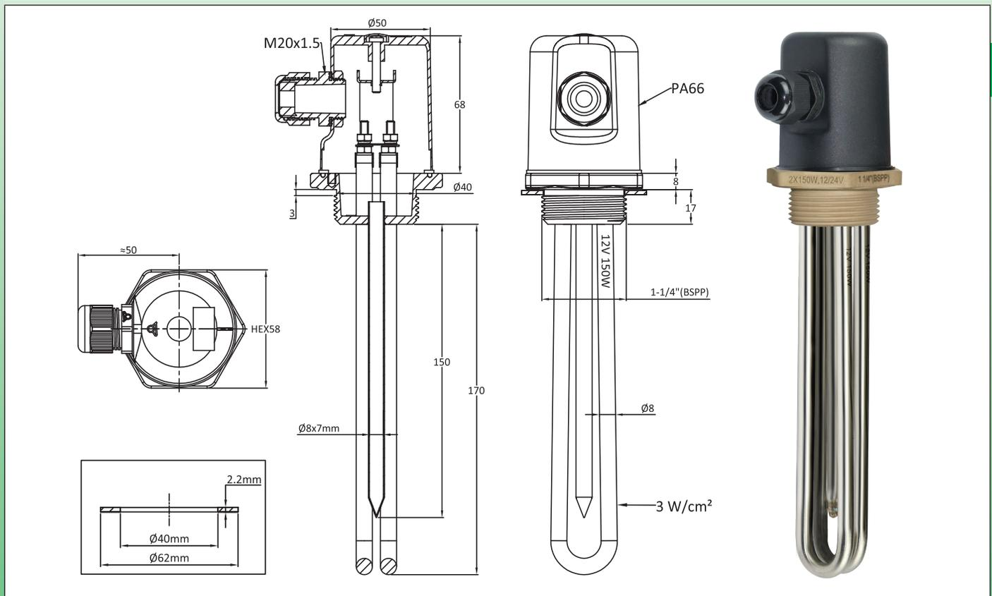
**Hauptanwendung:** direkte Nutzung von Niederspannungsstrom, der von Windturbinen oder PV-Solarkollektoren erzeugt wird, zur Erwärmung von Flüssigkeiten, Warmwasserkreisläufen und Warmwasserspeichern. Diese Tauchheizer nutzen die überschüssige Energie, die nicht für die Haushaltsbeleuchtung oder kleine Elektrogeräte benötigt wird. Sie können auch zusätzlich zu den Warmwasserspeichern verwendet werden, wodurch der Stromverbrauch aus dem Versorgungsnetz reduziert wird.
