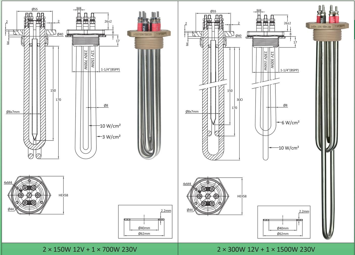
**Hauptanwendung:** direkte Nutzung von Niederspannungsstrom, der von Windturbinen oder PV-Solarkollektoren erzeugt wird, zur Erwärmung von Flüssigkeiten, Warmwasserkreisläufen und Warmwasserspeichern. Diese Tauchheizer nutzen die überschüssige Energie, die nicht für die Haushaltsbeleuchtung oder kleine Elektrogeräte benötigt wird. Sie können auch zusätzlich zu den Warmwasserspeichern verwendet werden, wodurch der Stromverbrauch aus dem Versorgungsnetz reduziert wird.
