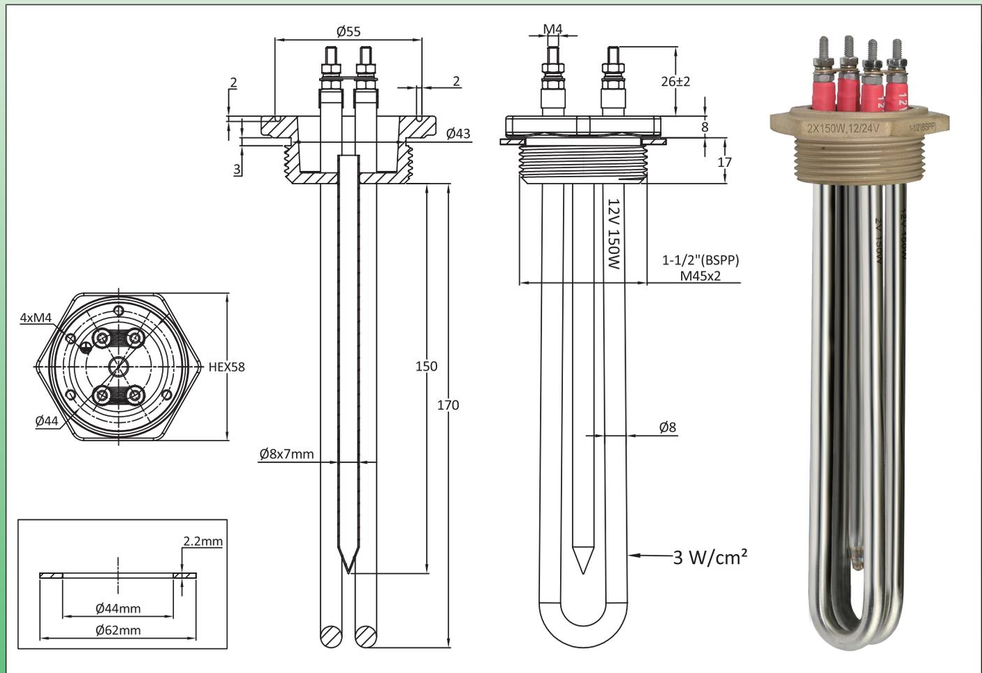
**Hauptanwendung:** direkte Nutzung von Niederspannungsstrom, der von Windturbinen oder PV-Solkollektoren erzeugt wird, zur Erwärmung von Flüssigkeiten, Warmwasserkreisläufen und Warmwasserspeichern. Diese Tauchheizer nutzen die überschüssige Energie, die nicht für die Haushaltsbeleuchtung oder kleine Elektrogeräte benötigt wird. Sie können auch zusätzlich zu den Warmwasserspeichern verwendet werden, wodurch der Stromverbrauch aus dem Versorgungsnetz reduziert wird.
