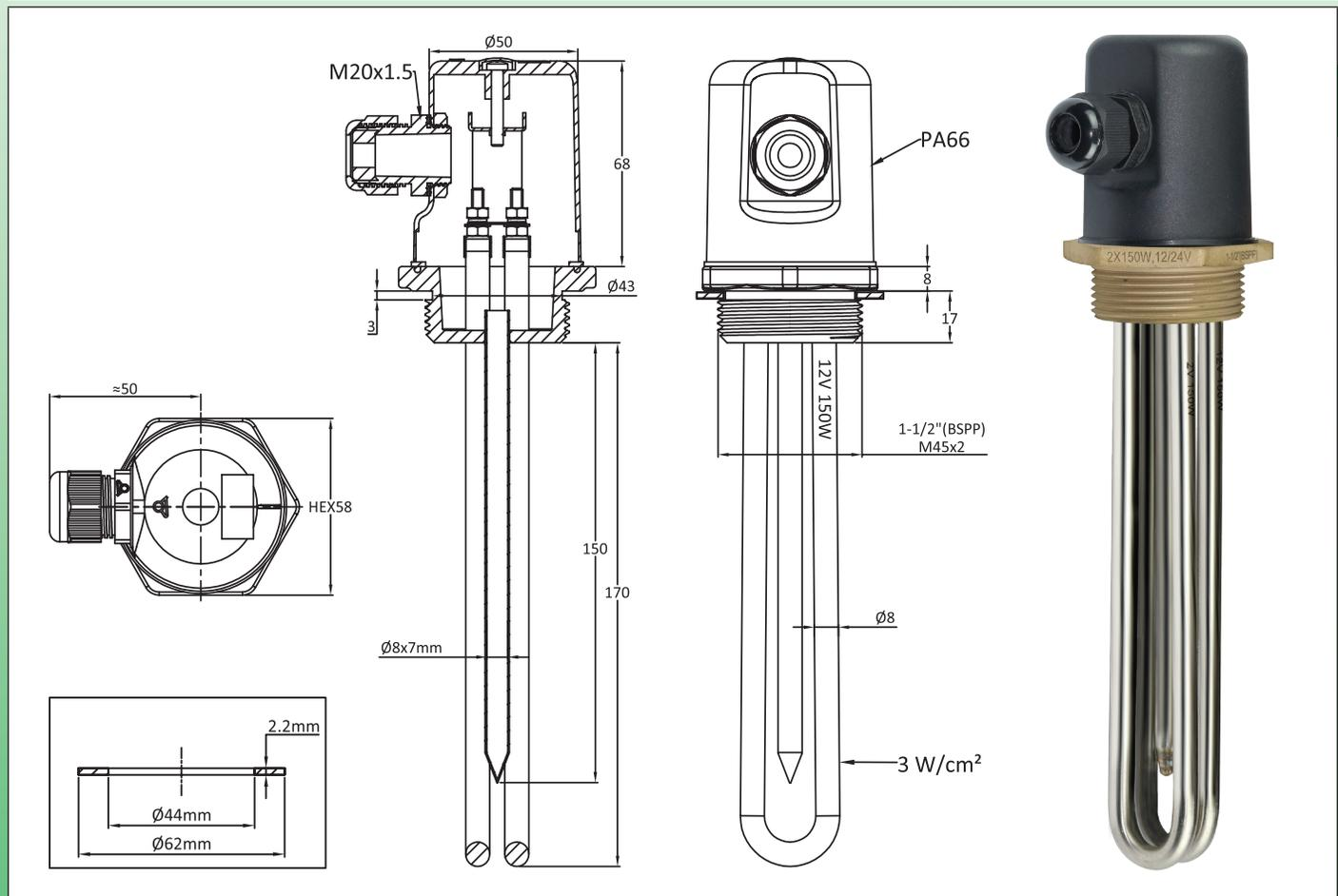
**Hauptanwendung:** direkte Nutzung von Niederspannungsstrom, der von Windturbinen oder PV-Solarkollektoren erzeugt wird, zur Erwärmung von Flüssigkeiten, Warmwasserkreisläufen und Warmwasserspeichern. Diese Tauchheizer nutzen die überschüssige Energie, die nicht für die Haushaltsbeleuchtung oder kleine Elektrogeräte benötigt wird. Sie können auch zusätzlich zu den Warmwasserspeichern verwendet werden, wodurch der Stromverbrauch aus dem Versorgungsnetz reduziert wird.
